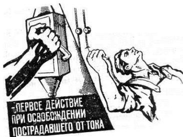
Рис. 1. Освобождение пострадавшего от действия при освобождении электротока путем отключения электроустановки в электроустановках -
